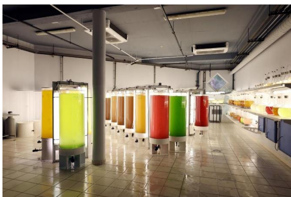
Figure 49: Cuves de cultures de microalgues de l'Eclosarium, Île de Houat, J-B Quentin in Le Parisien, 2018.
