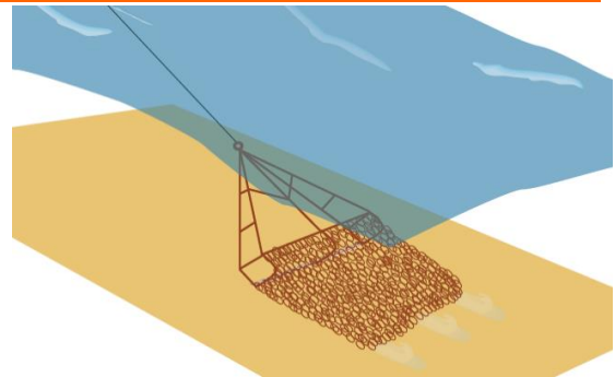
Drague bretonne à coquille St-Jacques. Source : CDPMEM29
