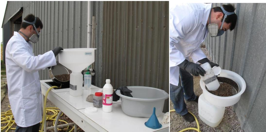
**Figure 27. Drainage et récupération de la solution formolée (gauche) avec un tamis 500µm, pour transfert des échantillons dans l'alcool (droite).**
