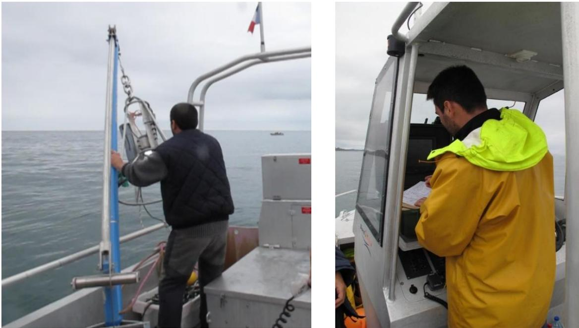
**Figure 111. Manipulation de la vidéo tractée à bord de l'Aronnax. Ci-contre, la sortie de l'eau par le treuil télécommandé de la caméra et d'un éclairage. Ci-dessous, la prise de note en temps réel à partir de l'écran de contrôle visible en arrière-plan.**
