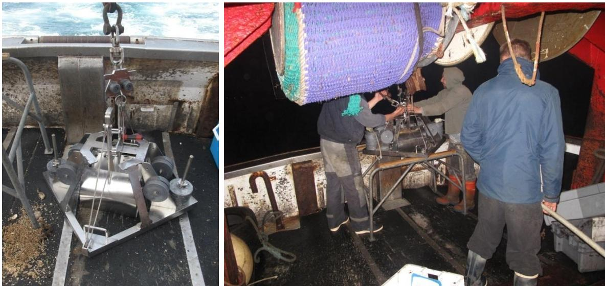
Figure 96. Aperçu de la benne Day Grab et de sa mise en oeuvre
