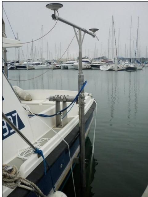
**Figure 180. Système de fixation sur perche à bord du Kristiansund**
