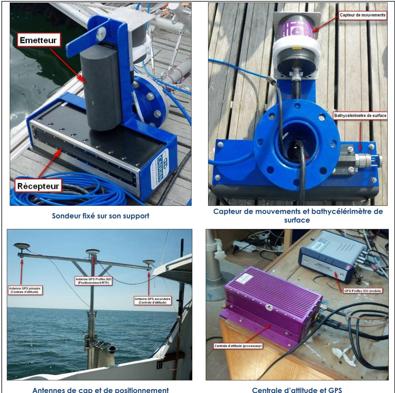
Figure 185. Système d'acquisition multifaisceaux
