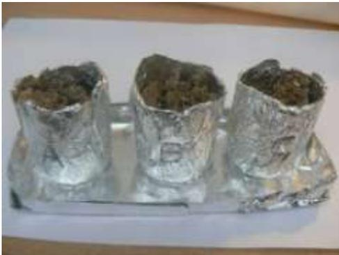
Trois sous échantillons ont été mesurés sur le même prélèvement de sédiment (Figure 12).
