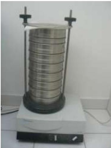
L'analyse granulométrique a été réalisée par tamisage à sec (tamiseuse électrique). 16 tamis de maille carrée (Norme AFNOR) ont été utilisés (Figure 10) : 64 mm, 10 mm, 6,3 mm, 5 mm, 3,15 mm, 2 mm, 1 mm, 710  $\mu\text{m}$ , 500  $\mu\text{m}$ , 355  $\mu\text{m}$ , 250  $\mu\text{m}$ , 180  $\mu\text{m}$ , 125  $\mu\text{m}$ , 90  $\mu\text{m}$ , 63  $\mu\text{m}$  et 45  $\mu\text{m}$ . Le tableau 1 récapitule les échelles et les dénominations granulométriques.
