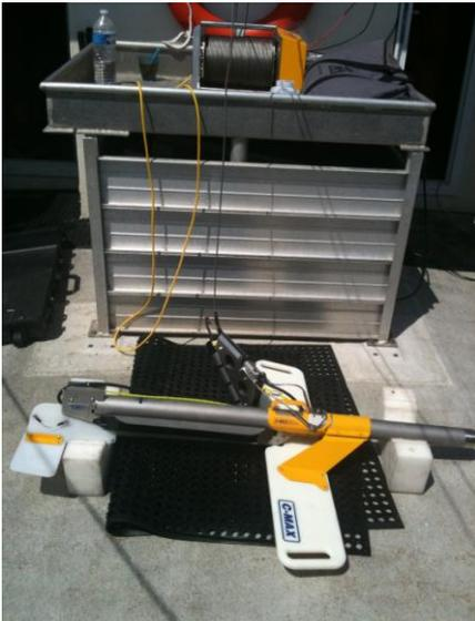
Le sonar utilisé pour cette étude est le sondeur CMAX (Figure 3). Il a été utilisé à une fréquence de 370 KHz avec une fauchée latérale de 150 m.
