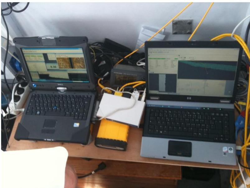
enregistrées sur l'interface du sondeur Ceeducer Pro. Ce réplicat permet de doubler l'information en cas de dysfonctionnement du logiciel HYPACK.
