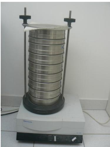
L'analyse granulométrique a été réalisée par tamisage à sec (tamiseuse électrique). 16 tamis de maille carrée (Norme AFNOR) ont été utilisés (Figure 10) : 64 mm, 10 mm, 6,3 mm, 5 mm, 3,15 mm, 2 mm, 1 mm, 710  $\mu\text{m}$ , 500  $\mu\text{m}$ , 355  $\mu\text{m}$ , , 250  $\mu\text{m}$ , 180  $\mu\text{m}$ , 125  $\mu\text{m}$ , 90  $\mu\text{m}$ , 63  $\mu\text{m}$ , 45  $\mu\text{m}$ . Le tableau 1 récapitule les échelles et les dénominations granulométriques.
