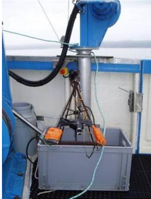
Figure 5 : Caméra sous-marine. (Cliché TBM)
