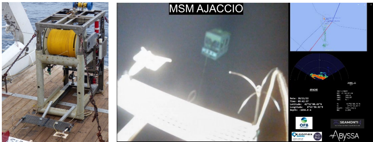
Photographie 4: Modification de la TMS et localisation/récupération du ROV "Apache" par la TMS
