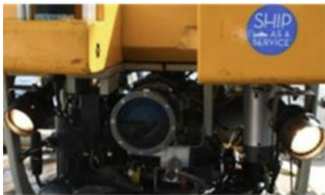
Caméra principale (caisson)
