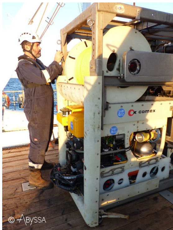
Photographie 2: ROV « Apache » dans sa cage TMS
