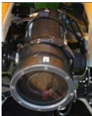
Caméra secondaire (caisson)
