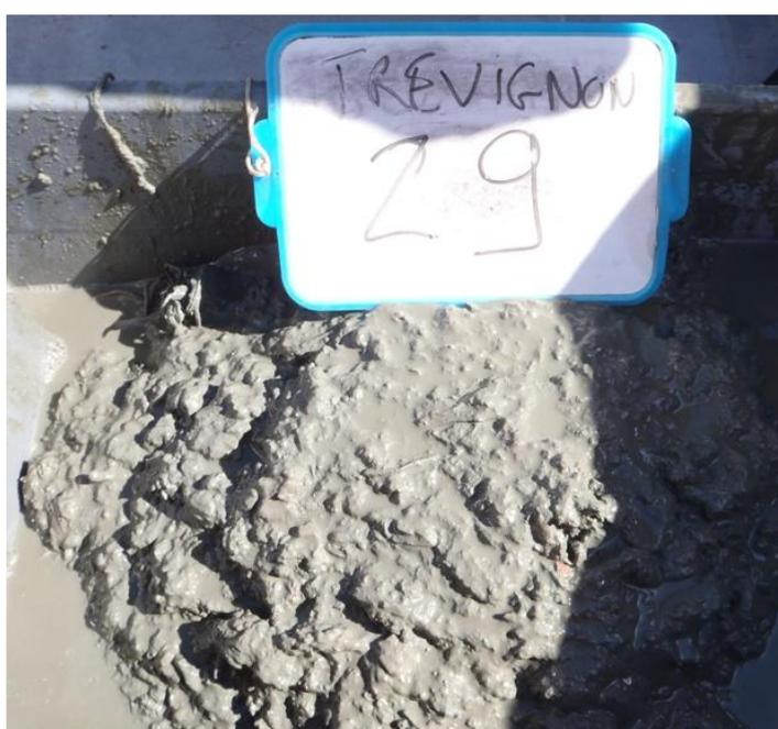
Figure 21 : Illustrations des différents types sédimentaires observés. De haut en bas et de gauche à droite : Gravier sableux (TN19), Sables fins propres (TN16) et Vases sableuses (TN29).
