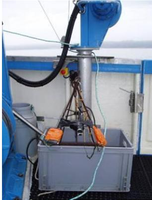
Figure 5 : Caméra sous-marine. (Cliché TBM)
