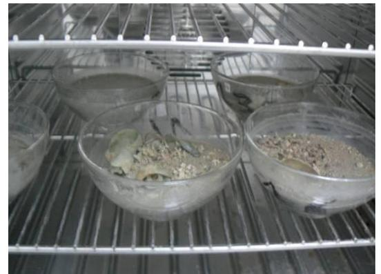
Figure 11 : Echantillons granulométriques à l'étuve (Cliché TBM).
