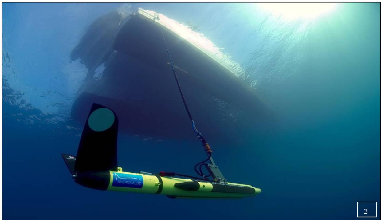
**Figure 16: Levé sonar latéral Klein 3900 [1] DGPS, micro-ordinateur avec logiciel SonarPro et enregistreur numérique ; [2] Retour contrôle pour pilote ; [3] Poisson relié au bateau par le câble électroporteur.**
