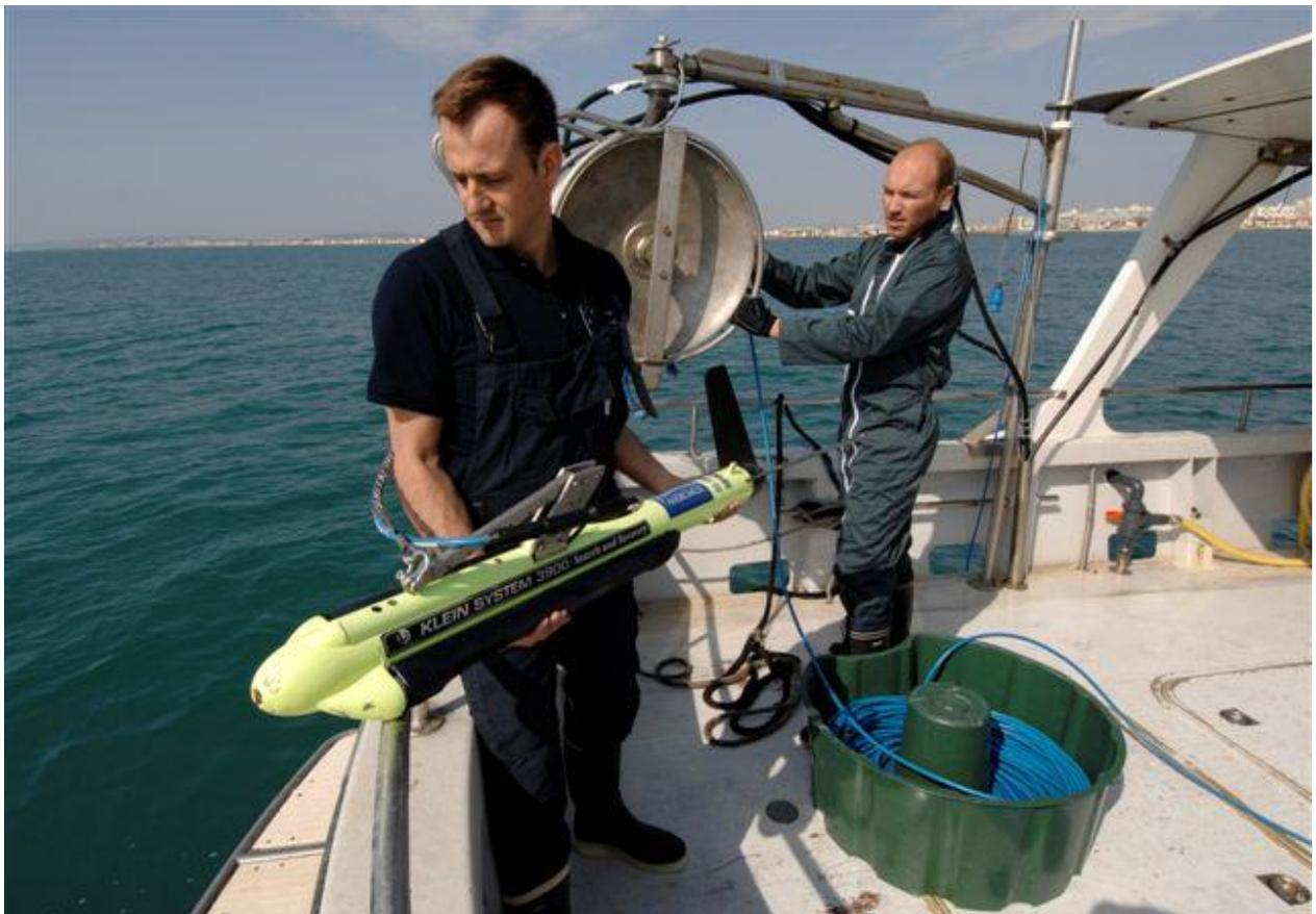
**Figure 18 : Mise à l'eau du sonar Klein 3900.**
