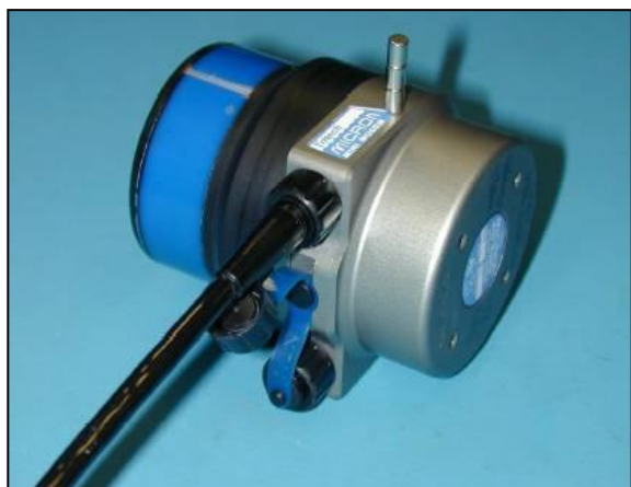
Figure 15 : Le système de GPS sous-marin Tritech est composé d'un transpondeur emporté par le plongeur (1), d'un transducteur fixé sous le bateau (2) et d'un module de calcul (3).
