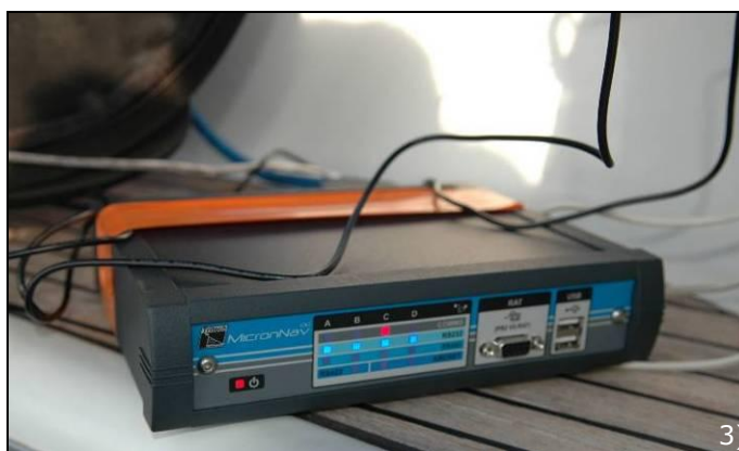
Figure 29 : Le système de GPS sous-marin Trittech est composé d'un transpondeur emporté par le plongeur (1), d'un transducteur fixé sous le bateau (2) et d'un module de calcul (3).
