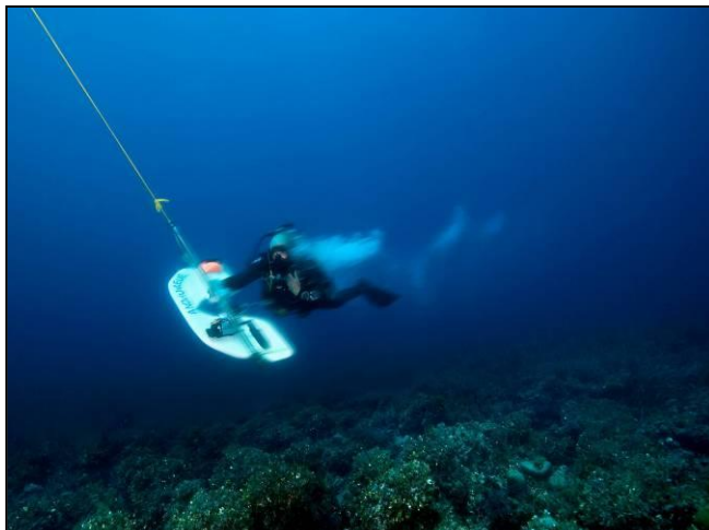
Figure 27 : La technique de transects plongeur audio permet la validation terrain de plusieurs milliers de points par un plongeur/biologiste le long de transects pouvant atteindre une vingtaine de kilomètres par jour d'acquisition.
