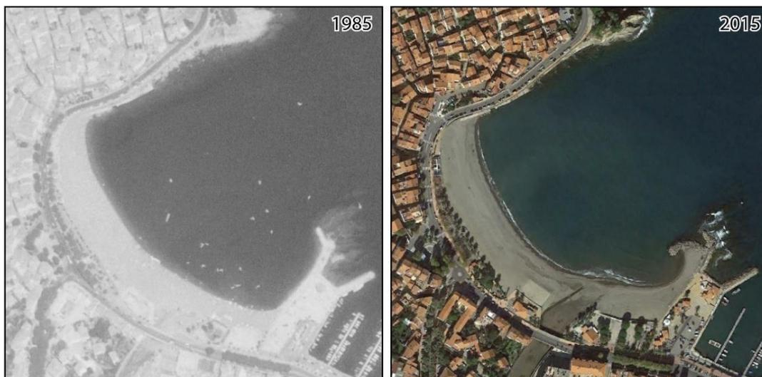
Figure 26 : influence de la construction d'un épi courbe anti-courant d'arrachement vers le large pour maintenir le sable charrié par la Baillaury sur la plage (données photographies aériennes IGN)
