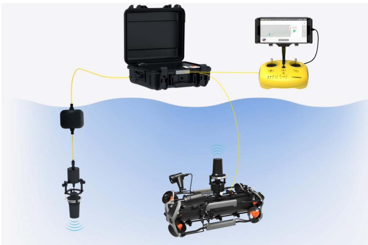
Figure 14 : Schéma du système de positionnement du ROV à l'aide du Sonar Cerulean Locator Mark II. (© Chasing)
